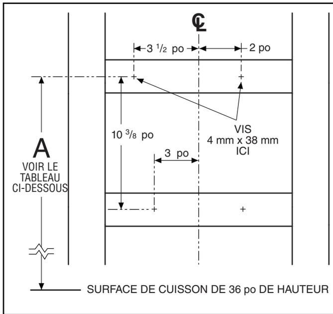
1. Construire un cadre mural en bois encastré entre les montants et au même niveau que ceux-ci. S'assurer que le cadre est centré avec l'emplacement de l'installation.
