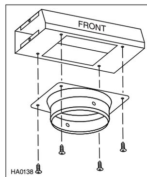
Fixer le conduit flexible de métal à l'adaptateur à l'aide d'une attache autobloquante (incluse). S'assurer que le côté « FRONT » est installé à l'avant de la hotte. Sceller le joint avec du ruban adhésif de métal.
