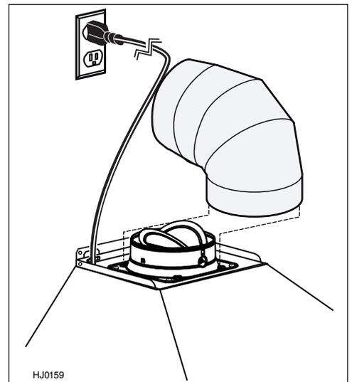
NOTE : Afin qu'il y ait suffisamment d'espace entre le dessus de la hotte et le support de montage du conduit décoratif inférieur, le coude doit être situé en dessous du support de montage pour laisser passer le conduit.
