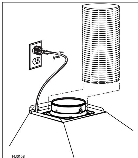
À l'aide de 4 vis ST4 x 8 incluses, assembler l'adaptateur rond de 6 po au plenum.
