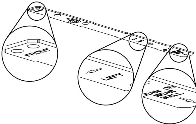
Consulte las marcas de los soporte para establecer el lado y la orientación correctos de la instalación (marcas en inglés solamente: *front* = parte delantera, *left* = izquierda, *lean on rear wall* = apoyar contra la pared trasera).
