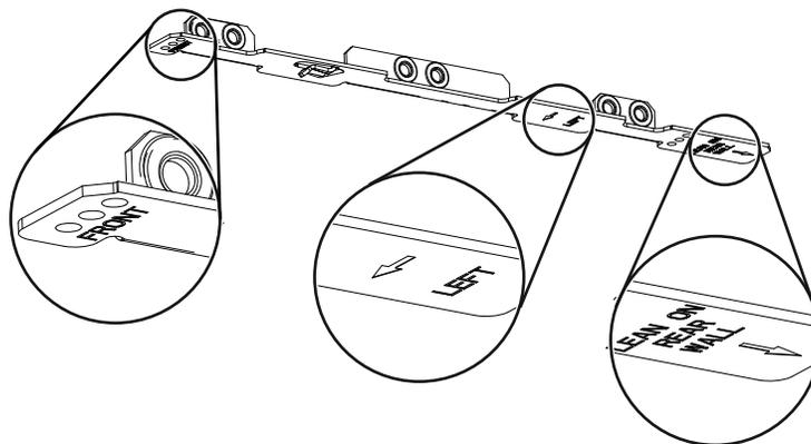
Consulte las marcas de los soporte para establecer el lado y la orientación correctos de la instalación (marcas en inglés solamente: *front* = parte delantera, *left* = izquierda, *lean on rear wall* = apoyar contra la pared trasera).
