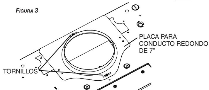
NOTA: Para adaptarse a un conducto descentrado, la placa para conducto redondo de 7" puede instalarse hasta  $1/2$ " de cada lado del centro de la campana.
