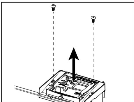
2 - Remove the two screws of the LCD screen cover. Enlever les deux vis du couvercle de l'écran ACL. Quitar los dos tornillos de la tapa de la pantalla LCD.
