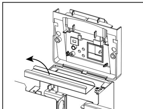
4 - Remove electrical compartment cover. Enlever le couvercle du compartiment électrique. Quitar la tapa del compartimento eléctrico.
