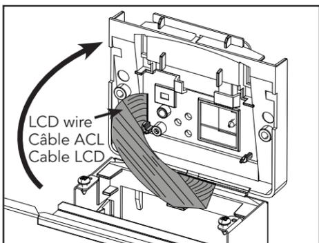
3 - Flip LCD screen cover. Basculer le couvercle de l'écran ACL. Incliner la tapa de la pantalla LCD.
