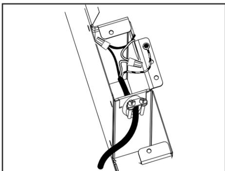
5 - Perform wiring connections. Effectuer les branchements électriques. Realizar las conexiones eléctricas.
