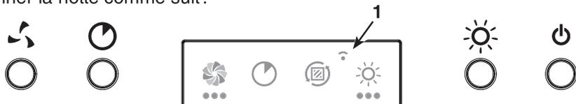
NOTE : Il est normal qu'au démarrage de la hotte ou qu'après une panne de courant, une petite icône (1) apparaisse furtivement (durant  $\pm$  2 secondes) à l'écran.
