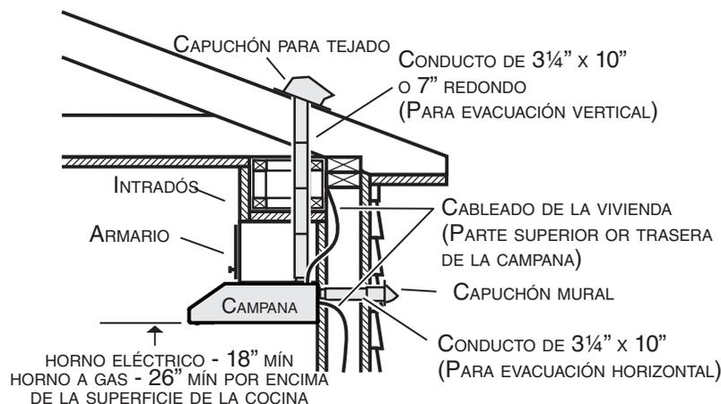
NOTA: Las distancias superiores a 30" son a discreción del instalador y del usuario.
