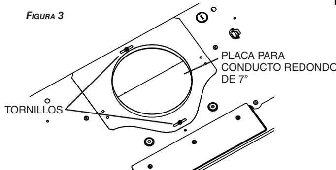
NOTA: Para adaptarse a un conducto descentrado, la placa para conducto redondo de 7" puede instalarse hasta 1/2" de cada lado del centro de la campana.
