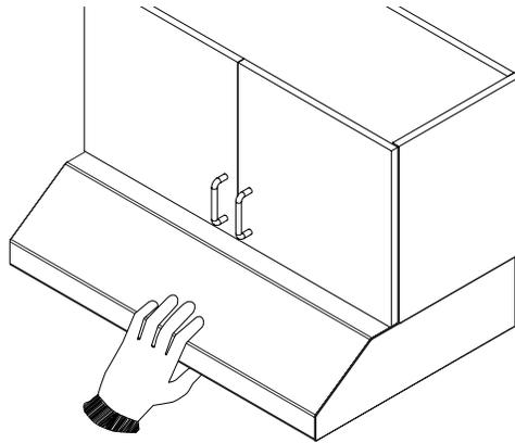
MIENTRAS MANTENIENDO LA CAMPANA, sujetar la campana al armario usando 4 tornillos para madera de cabeza redonda (incluidos en la bolsa de piezas). Usar 2 tornillos por lado.
