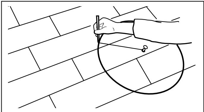
6. De l'extérieur du toit et en utilisant l'avant-trou comme point central, à l'aide d'un clou et d'une corde, tracez un cercle de 42 cm (16-1/2 po) de diamètre sur les bardeaux. Remarque : Si vous remplacez un ancien ventilateur, l'ouverture peut être plus grande que 42 cm (16-1/2 po), ce qui ne pose pas de problème tant que le revêtement du toit chevauche le contour du ventilateur d'au moins 5 cm (2 po) sur tous les côtés.
