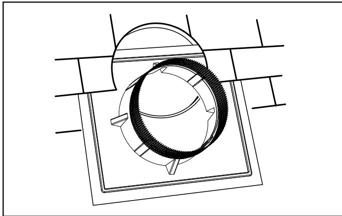
12. Aplique un cordón grande de cemento para techo en la ranura moldeada en la parte inferior de la base del ventilador. Asegúrese de que la base del ventilador esté paralela a la saliente del techo, inicie en los dos tercios inferiores del cuadrado de 27 pulg. (68.6 cm) y deslice la base del ventilador debajo de las tejas. No doble las tejas más de lo necesario. Centre la base del ventilador sobre el orificio.
