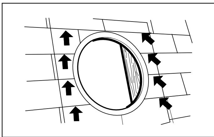
8. Usando el mismo clavo y el cordón indicados en el paso 6, marque un círculo de 14 pulg. (35.6 cm) de diámetro sobre el papel negro o la cubierta del techo. Nota: Si reemplaza un ventilador existente, el diámetro del orificio puede ser mayor de 14 pulg. (35.6 cm). Esto es aceptable, siempre y cuando la base del ventilador tenga un buen soporte en la cubierta del techo.
