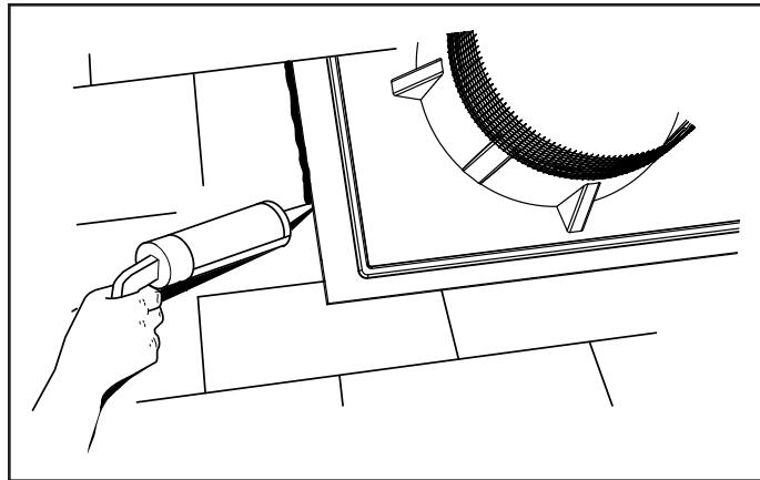
14. Imperméabilisez les bardeaux et les têtes de vis à l'aide d'un enduit à toiture de bonne qualité. N'IMPERMÉABILISEZ PAS le bord inférieur de la base du ventilateur.
