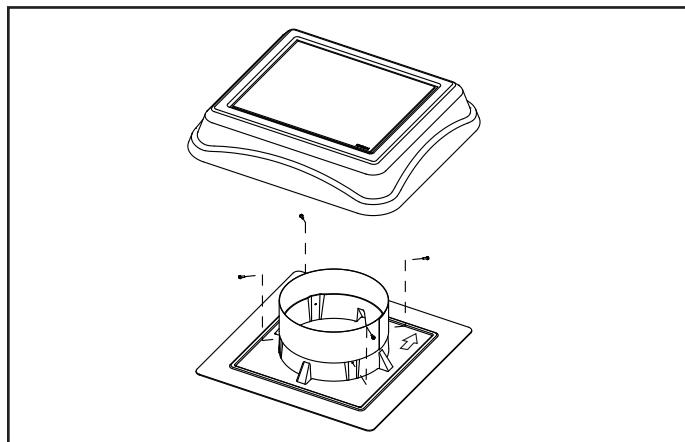
15. Positionner le dôme ventilateur de sorte que les points supérieurs vers l'arête de toit. Installez le dôme du ventilateur sur la base du ventilateur à l'aide des quatre (4) vise à tôle enlevées à l'étape 3. Retirez le carton du panneau solaire et vérifiez le fonctionnement du ventilateur.
