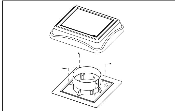
3. Séparez le dôme du ventilateur de sa base en enlevant les quatre (4) vis à tôle. Mettez le dôme de côté.
