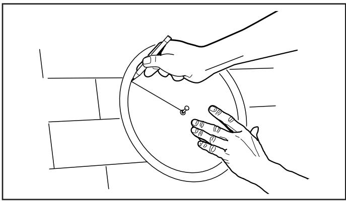
8. En utilisant toujours l'avant-trou de l'étape 6 comme point central, à l'aide d'un clou et d'une corde, tracez un cercle de 35,6 cm (14 po) de diamètre sur le papier noir ou le panneau du toit. Remarque : Si vous remplacez un ancien ventilateur, le diamètre de l'ouverture peut être plus grand que 35,6 cm (14 po), ce qui ne pose pas de problème tant que la base du ventilateur est bien soutenue par les panneaux du toit.
