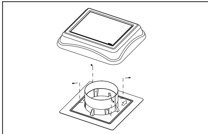
15. Coloque el domo del ventilador por lo que los puntos principales hacia el caballete del tejado. Instale el domo sobre la base del ventilador usando los cuatro (4) tornillos de lámina metálica que quitó en el paso 3. Quite el cartón del panel solar y asegúrese de que el ventilador funcione.
