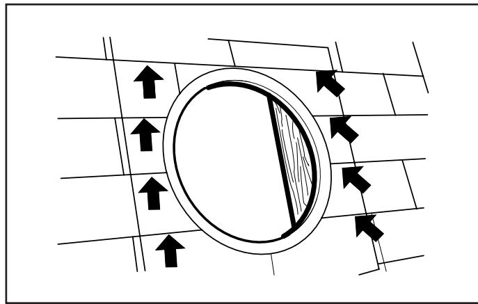
11. Pour enlever correctement les clous à toiture, tracez un carré de 68,6 cm (27 po) de côté, centré sur l'ouverture. Enlevez les clous retenant les bardeaux sur les deux tiers supérieurs du carré.
