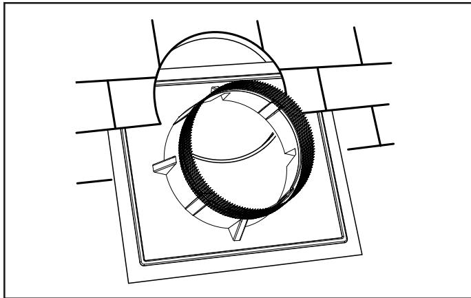
12. Appliquez un gros cordon d'enduit à toiture dans la rainure du dessous de la base du ventilateur. Assurez-vous que la base du ventilateur est parallèle à la ligne du faîte, glissez la base du ventilateur sous les bardeaux des deux tiers supérieurs du carré de 68,6 cm (27 po). Ne pliez pas les bardeaux plus que nécessaire. Centrez la base du ventilateur sur l'ouverture.
