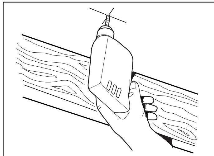
5. Haga un orificio guía a través del techo en esta marca.
