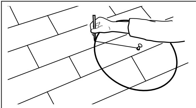
6. Desde el lado del techo, usando el orificio guía como punto central, use un clavo y un cordón para marcar un círculo de 16 1/2 pulg. (42 cm) de diámetro sobre las tejas. Nota: Si reemplaza un ventilador existente, el diámetro del orificio puede ser mayor de 16 1/2 pulg. (42 cm). Esto es aceptable, siempre y cuando el material del techo se traslape al ventilador por lo menos 2 pulg. (5 cm) en todos los lados.
