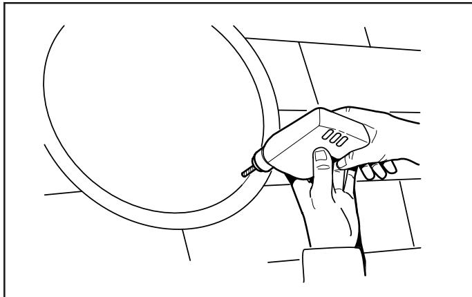
9. Perfore un orificio iniciador grande para la sierra de vaivén, justo dentro de la línea o del círculo de 14 pulg. (35.6 cm) creado en el paso 8.
