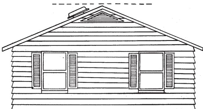
1. Déterminez l'emplacement le plus exposé au soleil sur le toit et sans ombre (arbres, autres bâtiments, etc.) à 16 h dans le mois le plus chaud de l'année. En règle générale, nous recommandons un point situé à environ 61 à 91 cm (24 à 36 po) au centre en dessous du faîte du toit et centré sur le pan sud, sud-ouest ou ouest du toit.
