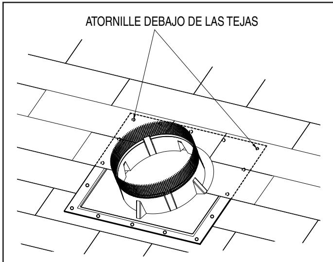
13. Asegúrese de que la base del ventilador esté paralela a la saliente del techo, y con cuidado levante las tejas y atornille la base firmemente al techo usando tornillos para madera galvanizados cabeza aplanaada #10 x 1 pulg. Atornille todas las esquinas y alrededor del perímetro de la base cada 6 pulgadas (15 cm).
