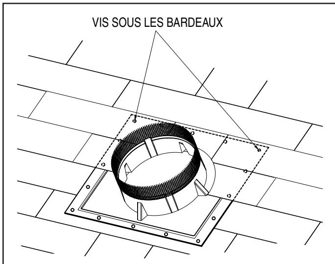
13. Assurez-vous que la base du ventilateur est parallèle à la ligne du faîte, soulevez délicatement les bardeaux et vissez la base solidement sur le toit à l'aide de vis à bois galvanisées à tête aplatie n° 10 x 1 po. Vissez les coins et le pourtour de la base à tous les 15 cm (6 pouces).
