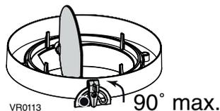
3. Serrer à la main la vis de blocage du levier du volet pour maintenir le volet ouvert en place.
