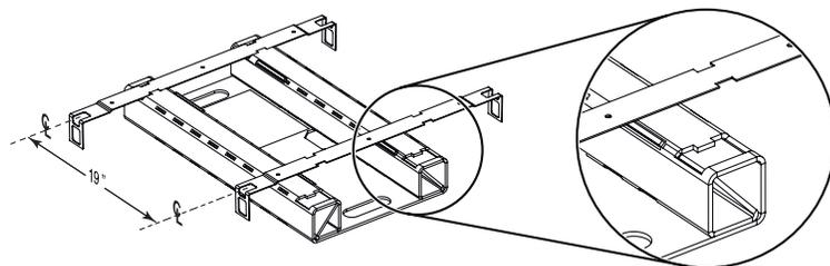
1. À l'aide du gabarit imprimé sur le carton de protection dans la boîte de l'appareil, fixer les supports aux solives.
