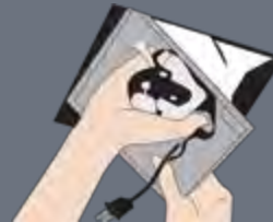
2. Remove old fan assembly
