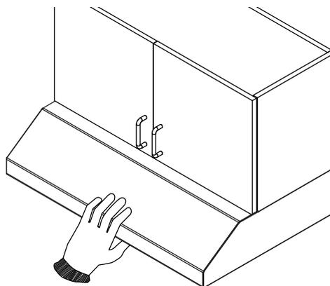
TOUT EN TENANT LA HOTTE, fixer la hotte à l'armoire à l'aide de 4 vis à bois à tête ronde (incluses dans le sac de pièces). Utiliser 2 vis par côté.
