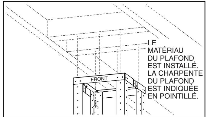
1. Déterminer la longueur « L » de l'ensemble de cadre selon la hauteur d'installation souhaitée. (Voir le tableau ci-dessous.) Pour régler la hauteur du cadre, enlever les huit (8) vis, glisser la section supérieure à la hauteur voulue, replacer et serrer les vis fermement.
