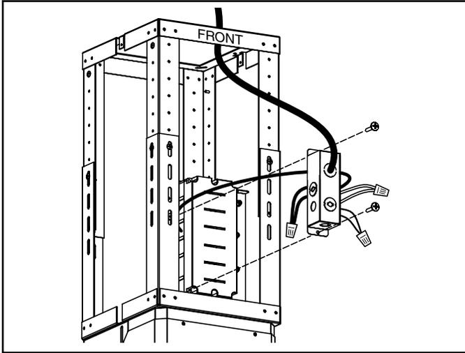
1. Retirer le couvercle du boîtier de câblage et effectuer les connexions entre le câble d'alimentation domestique et la hotte: le fil NOIR avec le NOIR, le BLANC avec le BLANC et le VERT avec le VERT. Remettre en place le couvercle.
