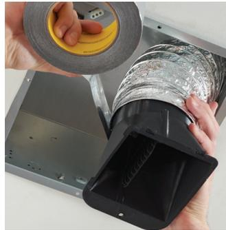
**Le raccord de conduit EzDuct<sup>MC</sup>** permet d'installer un nouveau ventilateur sans passer par le grenier. Il suffit d'installer le boîtier, d'y introduire le conduit, de fixer le raccord EzDuct<sup>MC</sup> et de remettre le tout en place au moyen d'une seule vis.
